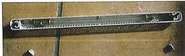
Avant nettoyage la grille est bouchée par la poussière, après rinçage l'air peut entrer correctement.
